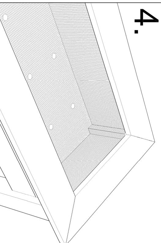
Befestigen Sie die Noppenfolie und schneiden diese zu. Die Noppen müssen hierbei zur Holzseite zeigen.
