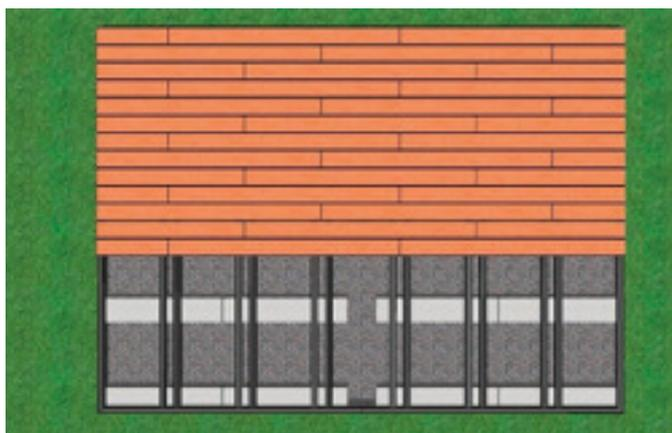
Ossature, sous-construction et pont pour un décalage de 1/3 de la longueur. Cotes d'axe : 500-117-500-117-500 mm
