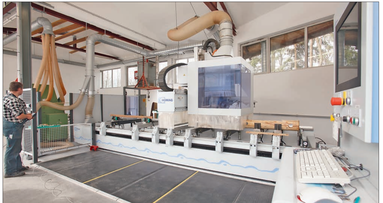
Das Fünf-Achs-Bearbeitungszentrum „BOF 211“ von Homag
