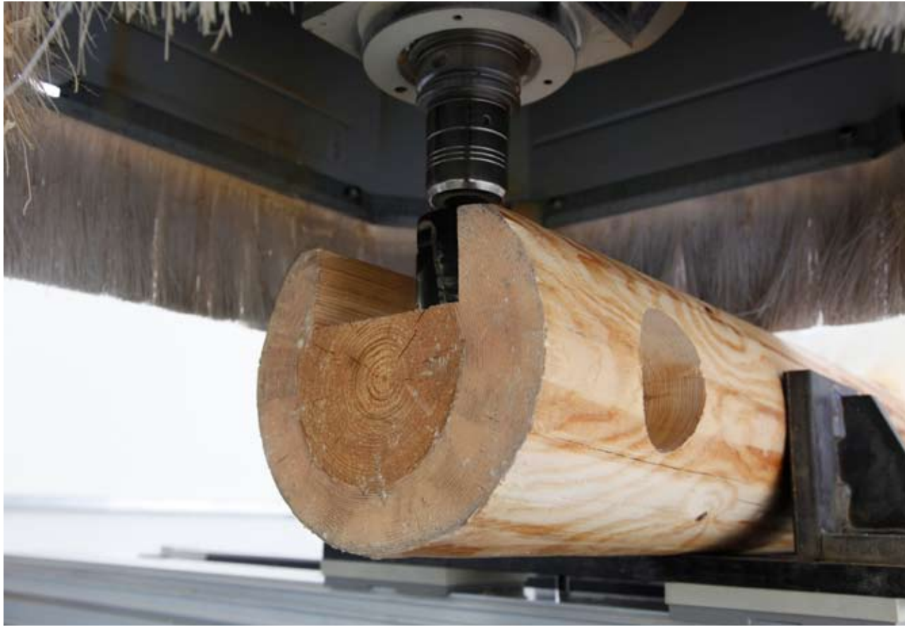
Pfosten für Holzleitplanken (Ausfräsung für U-Stahl)
