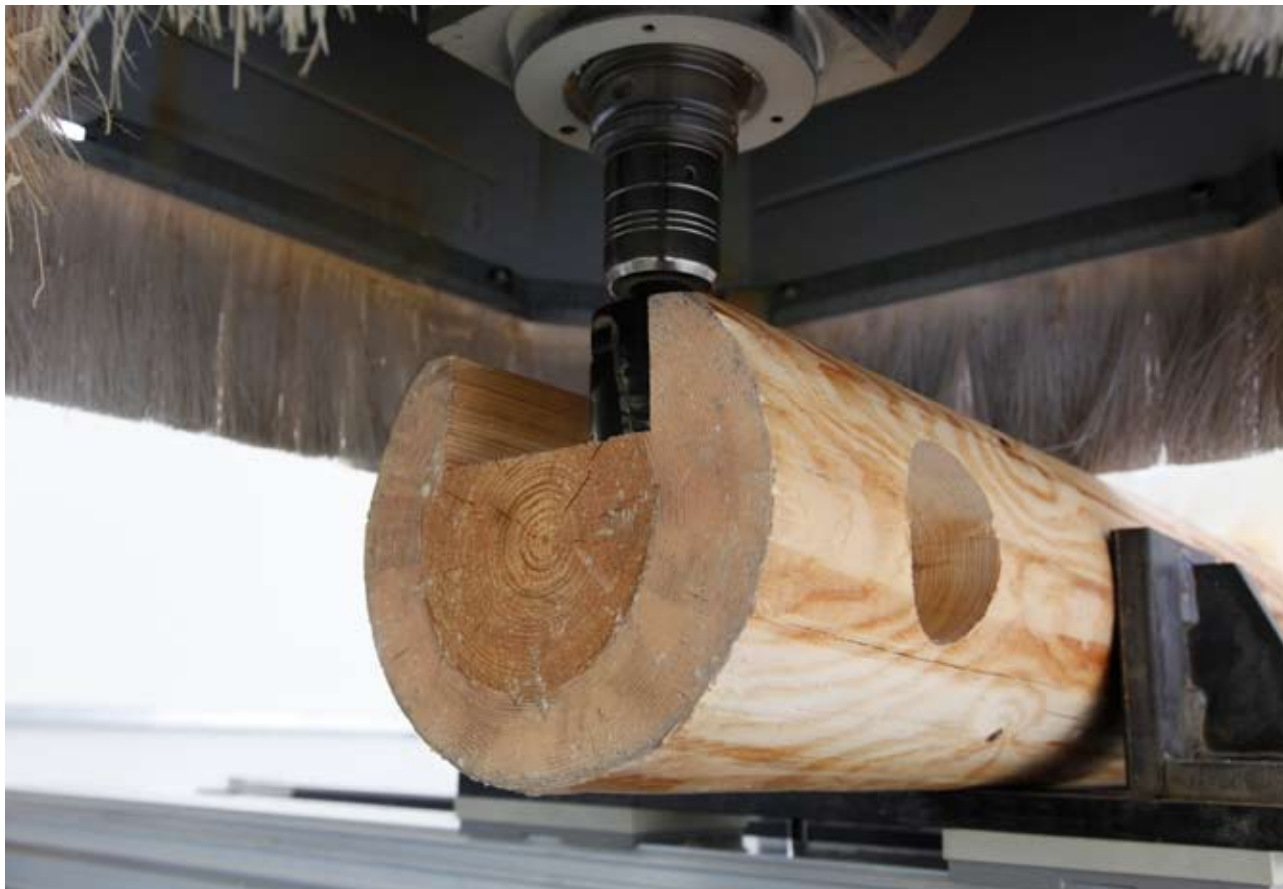
Pfosten für Holzleitplanken (Ausfräsung für U-Stahl)
